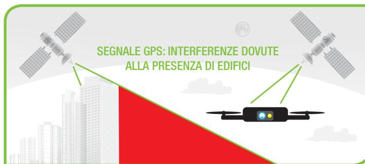
SEGNALE GPS: INTERFERENZE DOVUTE ALLA PRESENZA DI EDIFICI
