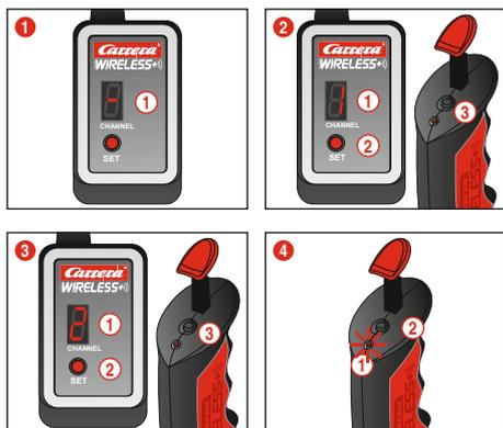
Pour que les commandes manuelles puissent être utilisées pour commander les véhicules, elles doivent toutes être « reliées » au récepteur. Mettez le circuit en marche.
