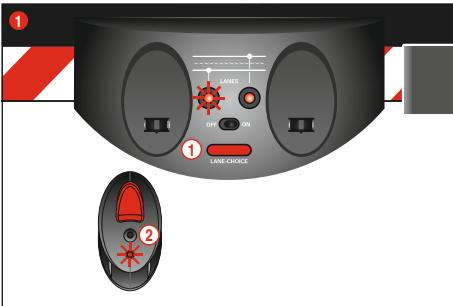
Damit die Handregler zur Steuerung der Fahrzeuge genutzt werden können müssen sie einmalig an die Anschlusssschiene „gebunden“ werden. Schalten Sie dazu die Bahn ein. Die beiden Kontroll-LED's der Anschlusssschiene leuchten permanent.
