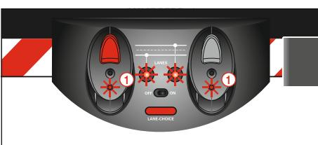
Bei Nichtbetätigung des Handreglers schaltet sich dieser nach ca. 30 Sek. selbstständig in den Stromsparmodus. Durch Drücken des Stößels bzw. der Weichtasten kann der Handregler wieder aktiviert werden.
