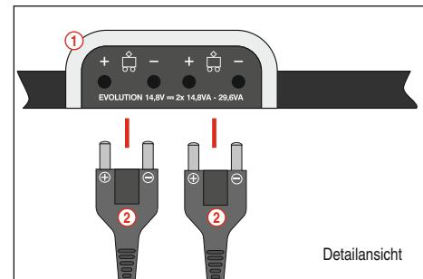
Verbinden Sie die beiden Stecker (2) des Transformators mit den Anschlussbuchsen (1) der Anschlusschiene.
