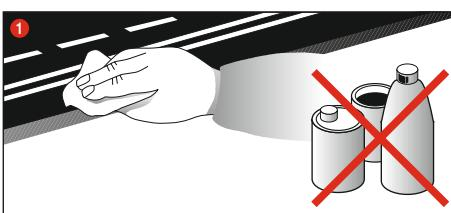
Um eine einwandfreie Funktion der Autorennbahn zu gewährleisten, sollten alle Teile der Rennbahn regelmäßig gereinigt werden. Vor der Reinigung den Netzstecker ziehen.
