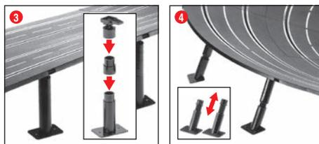
**1 Glissières de sécurité:** les supports des glissières de sécurité seront installés en les montant par bascule sur les bords de la piste.
