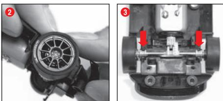
Détacher la partie supérieure du véhicule du châssis selon Fig. 1. Extraire les axes des points d'appui en exerçant une pression (2). Insérer de nouveaux axes. Veiller à ce que les paliers soient dans la position correcte (3).
