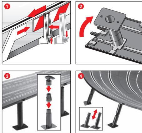
**1** **Glissières de sécurité:** les supports des glissières de sécurité seront installés en les montant par bascule sur les bords de la piste.
