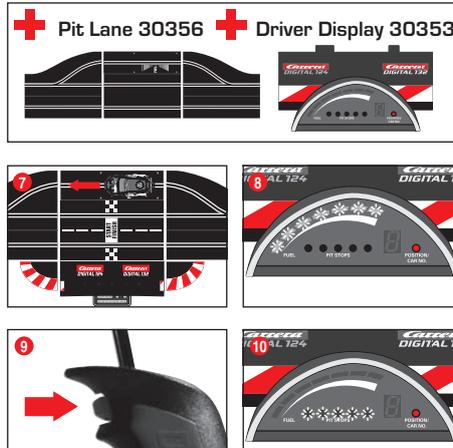
Der aktuelle Tankinhalt des Fahrzeuges kann über die Balkenanzeige mit 5 grünen und 2 roten LEDs des Driver Displays abgelesen werden. Zum Auftanken mit dem Fahrzeug in die Pit Lane über den Tanksensor fahren Abb. (7). Die Balkenanzeige beginnt nun zu blinken, Abb. (8), und das Fahrzeug kann über das Festhalten der Weichentaste aufgetankt werden Abb. (9). Die Anzahl der Tankvorgänge wird durch Blinken bzw. Leuchten der gelben LEDs angezeigt, Abb. (10) (siehe auch Driver Display).
