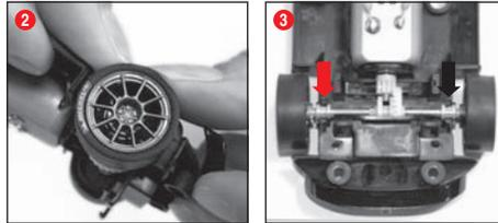
Fahrzeugoberteil von Chassis gem. Abb. ① lösen. Achsen mit Druck aus den Lagerstellen herauslösen Abb. ②. Neue Achse einlegen. Auf korrekte Position der Achslager achten, Abb. ③.
