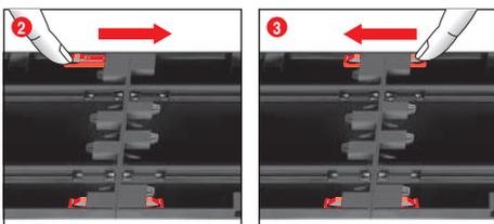
**1 + 2 + 3** Vor dem Aufbau Verbindungsclips wie in Abb. 1 beschrieben in die Schiene stecken. Schienen auf einer ebenen Unterlage zusammenstecken. Verbindungsclips gem. Abb. 2 bis zum hörbaren Einrasten in Pfeilrichtung bewegen. Verbindungsclip kann auch nachträglich eingesteckt werden. Das Lösen der Verbindungsclips ist in beide Richtungen durch einfaches Herunterdrücken der Klemmnase möglich (siehe Abb. 3)
