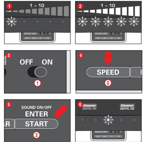
Die Einstellung der Grundgeschwindigkeit kann individuell für ein und/oder mehrere Fahrzeuge erfolgen. Die einzustellenden Fahrzeuge müssen sich dabei auf der Bahn befinden. Die Einstellung kann in 10 Stufen erfolgen wobei die 5 LEDs durch Blinken bzw. stetiges Leuchten die unterschiedlichen Stufen signalisieren.
