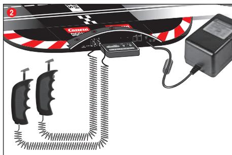
**1** Schließen Sie den Trafostecker an die Control Unit an.
