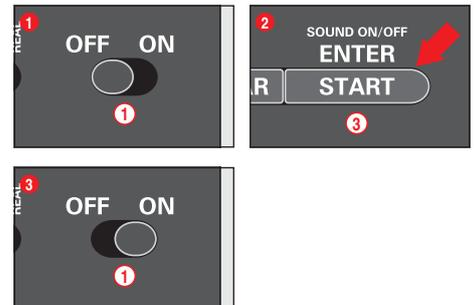
Der Bestätigungston beim Überfahren der Sensoren und der Tastenbedienung kann abgeschaltet werden. Halten Sie hierfür die „START/ENTER“ Taste (3) bei ausgeschalteter Control Unit gedrückt, schalten Sie die Bahn ein und lassen die „START/ENTER“ Taste (3) wieder los. Der Quittierungston beim Einschalten der Control Unit kann jedoch nicht ausgeschaltet werden.
