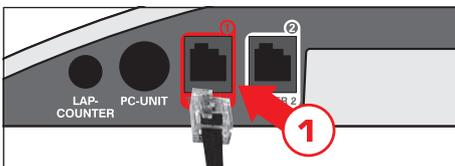
Handreglererweiterungsbox (Art.-Nr. 30348) an Buchse 1 der Control Unit anschließen. Weitere Vorgehensweise siehe Abschnitt "Codierung der Fahrzeuge auf entsprechenden Handregler".
