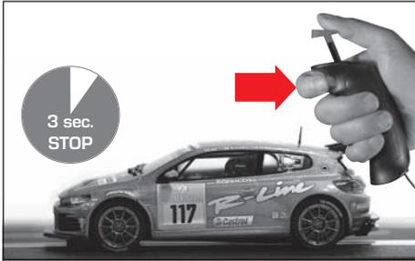
Auf Handregler programmiertes Fahrzeug muss sich mindestens 3 Sek. im Stillstand auf der Rennbahn befinden, bevor durch Drücken der Weichentaste das Licht ein- bzw. ausgeschaltet werden kann.
