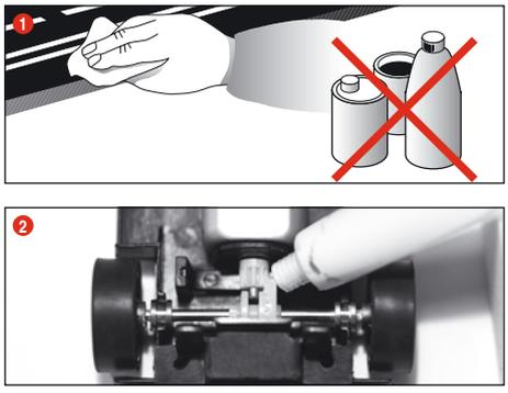
Um eine einwandfreie Funktion der Autorennbahn zu gewährleisten, sollten alle Teile der Rennbahn regelmäßig gereinigt werden. Vor der Reinigung den Netzstecker ziehen.
