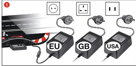
**1** Schließen Sie den Trafostecker an die Control Unit an.
