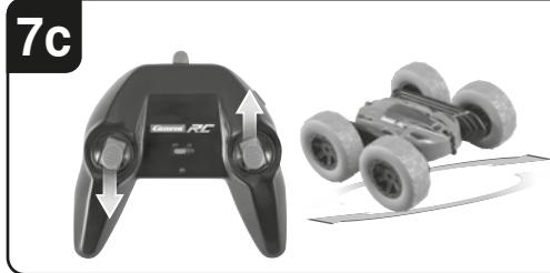
ck sinistro e destro. Un movimento di sterzata a sinistra viene creato spostando il joystick destro in avanti e rilasciandolo. Joystick sinistro in avanti e poi rilasciarlo.
