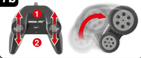
**D** Controller-Funktionen**7 a** Differentialsteuerung
