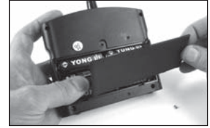
3. Pil bölümünün kapağını kapatınız ve vidalarını sıkıştırınız.
