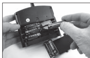
2. Inserire 6 batterie 1,5 V AA prestando attenzione alla polarità indicata nel vano batterie.
