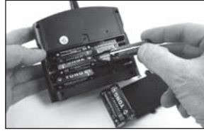
2. 6 x 1,5 V AA pilleri yerleştiriniz ve pil bölümünde belirtildiği şekilde polarite verilerine dikkat ediniz.
